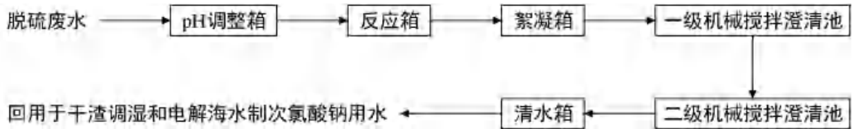
图 2.8-13 已建工程脱硫废水处理工艺流程图
