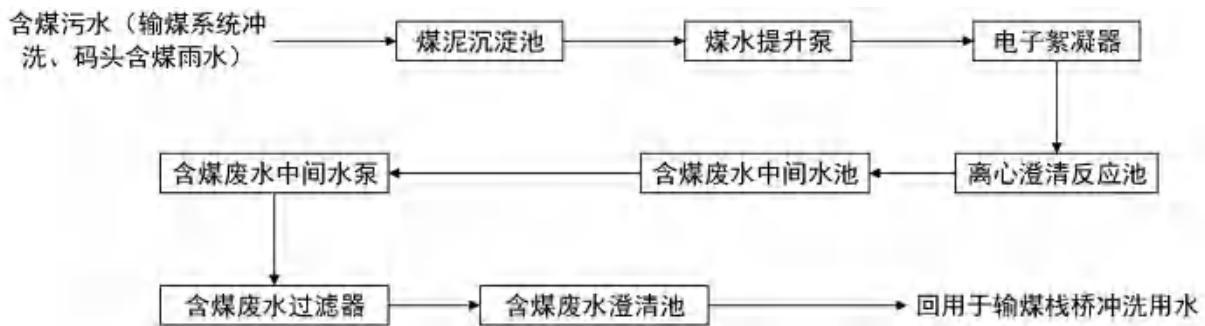
图 2.8-14 已建工程含煤废水处理工艺流程图
